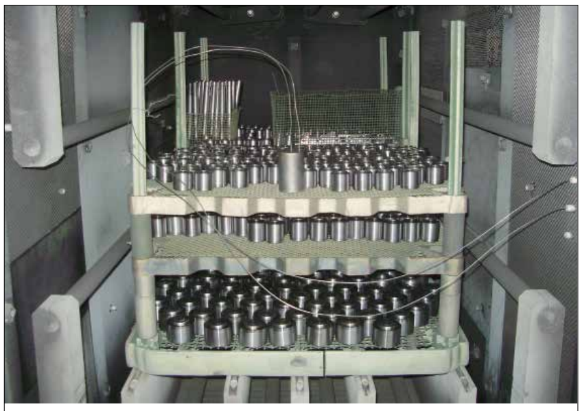
열전대의 사용은 열처리 중 여러 위치의 온도를 개괄적으로 확인할 수 있습니다. 사진 : voestalpine High Performance Metals CZ s.r.o.체코
