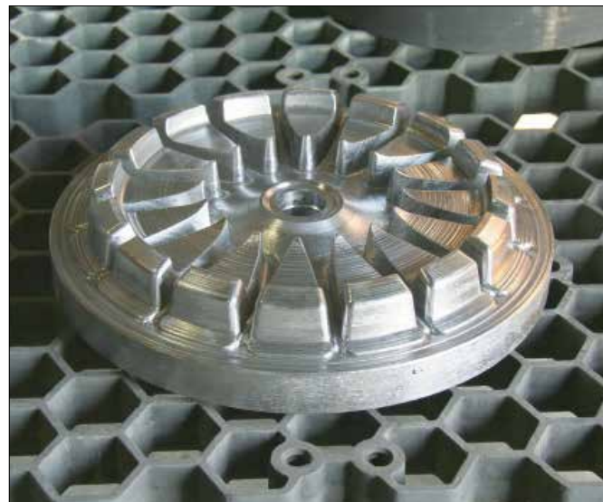
열처리 전 장입판에 위치시킨 알루미늄림용 하부 다이 사진 : voestalpine High Performance Metal Anonim Sirketi
