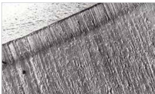
照片 1. D2冲头磨粒磨损扫描式电子显微镜照片（被加工材料：0.75%碳-钢，46HRC）
