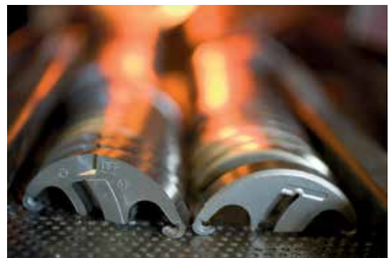
粉末压制零件的烧结
