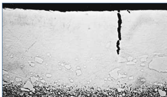
ASSAB XW-42粗电火花加工后的表面。白层的脆性和裂纹。
