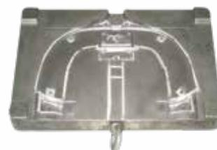
ABP処理は溶損を低減させることができます。
