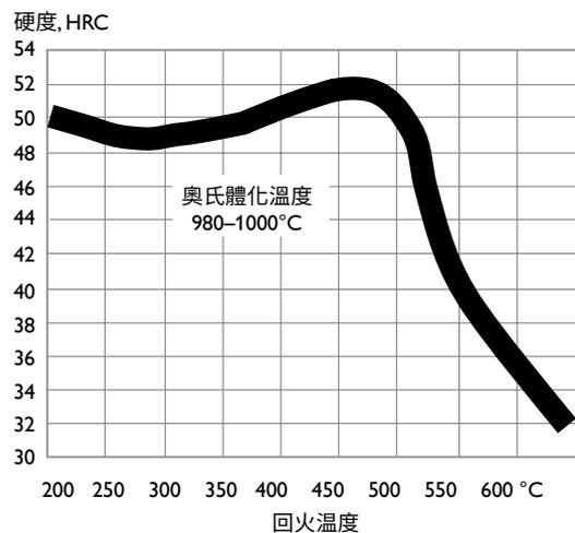
上述回火曲線是根據15×15×40mm尺寸的熱處理樣品，高壓氣冷後，取得的數據。模具熱處理後硬度會略低，這主要與實際工具尺寸和熱處理參數等因素有關。
